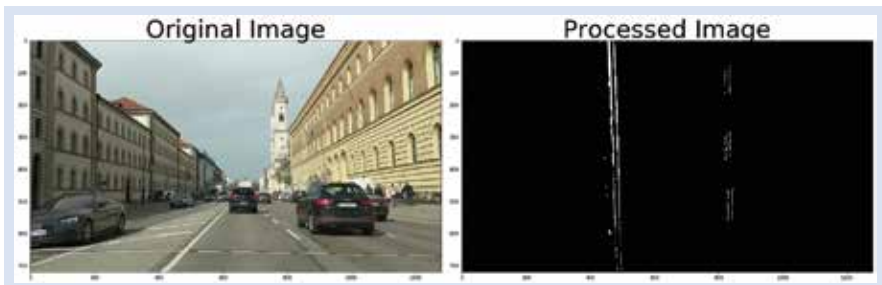
Szene einer Videoaufnahme (l) und Ergebnis der Spurerkennung (r)
