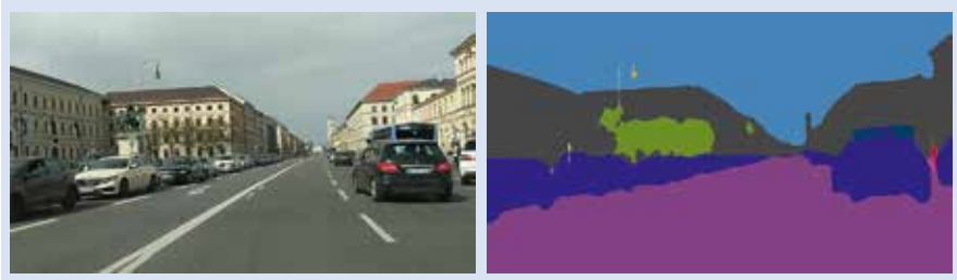
Kameraaufnahme (l) und mittels Machine Learning Verfahren bzw. künstlicher Intelligenz (KI) klassifizierte Segmentierung (r)
