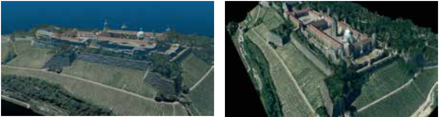
Bild 4: Dreidimensionale, kolorierte Punktwolke (links); 2,5-dimensionales Oberflächenmodell (rechts)
