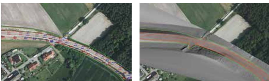
Bild 9: Editierbare Höhen an den digitalisierten Strukturlinien (links); Schummerung des mittels 3D-Strukturlinien abgeleiteten Ersatzgitters zur partiellen DGM-Fortführung
