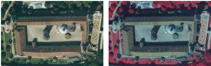
Bild 2: Digitales Orthophoto in 20 cm Bodenauflösung (DOP20) in Farbe (RGB) und Color-Infrarot (CIR20)
