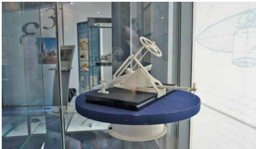
3D-Druck nach der vereinfachten Originalzeichnung von Johann Martin Hermanns Planimeter Foto: © LDBV
