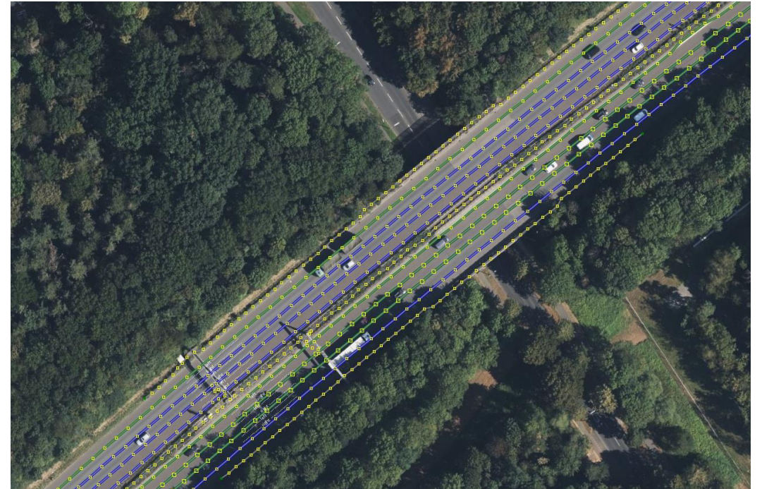
Automatisch erzeugter Straßenkorridor im lanelet2-Format auf Basis einer segmentierten Punktwolke
