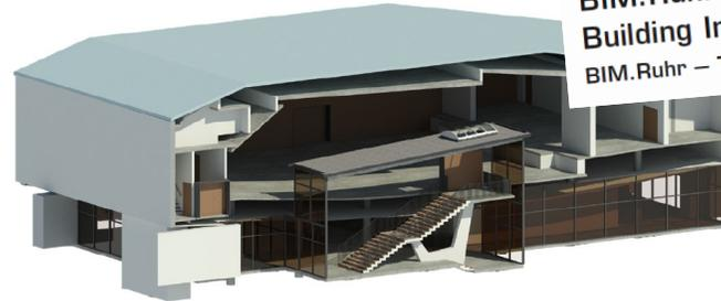
Abb. 4: BIM-Modell der Aula des Alice-Salomon-Berufskollegs in Bochum mit ausgeblendeten Außenwänden auf der zugewandten Blickseite (Quelle: BIM.Ruhr)
