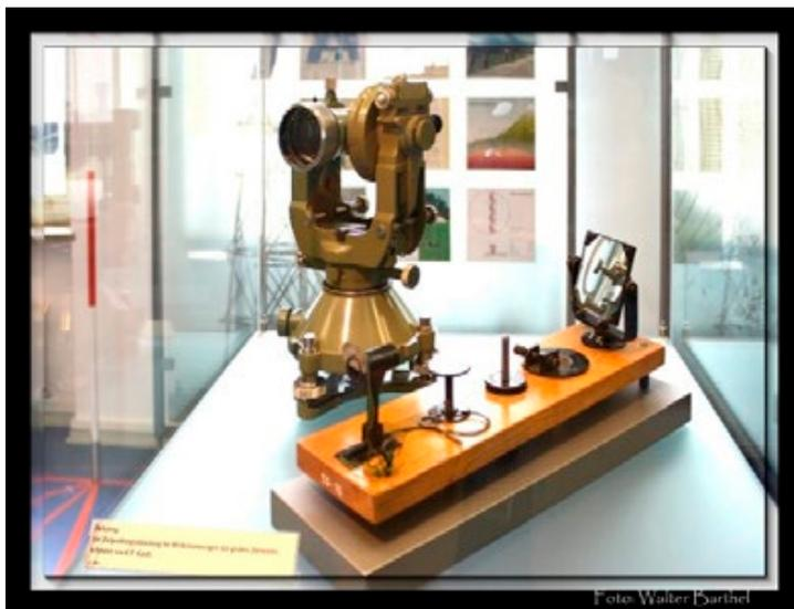
Abb. 4: Heliotrop (vorn rechts) und Wild T3–Theodolit
