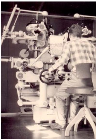
Abb. 8: Auswertung von Luftbildaufnahmen am Zeiss-Stereoplanigraph C8
