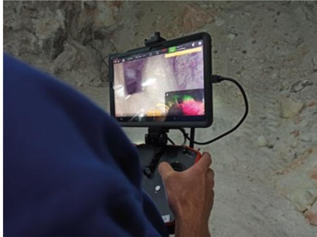
Abbildung 10: Funkfernbedienung (GCS-Ground Control Station) Elios 3
