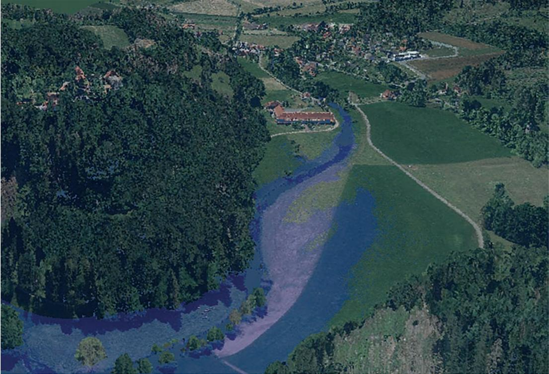
Abb. 5: Wasserstand der der Orke bei Dalwigksthalm bei einem Pegelanstieg um + 5 Meter
