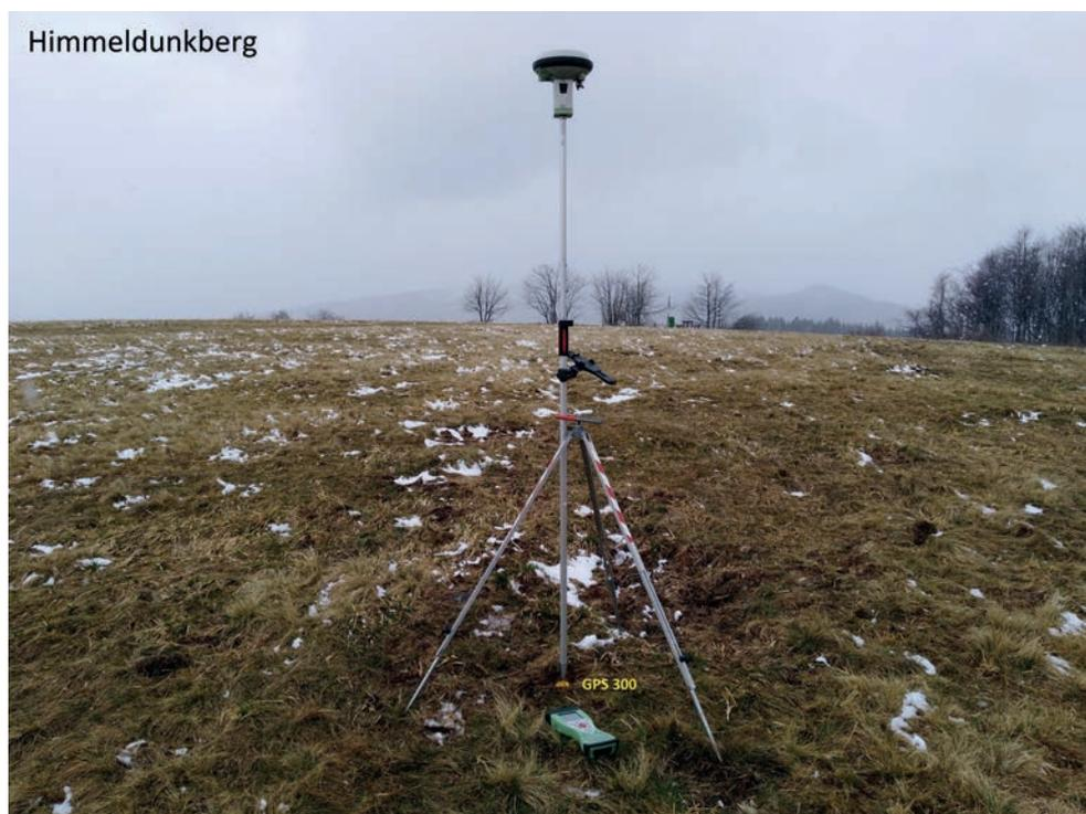
Abb. 24: Der Gipfelbereich des Himmeldunkberg mit GNSS-Rover
