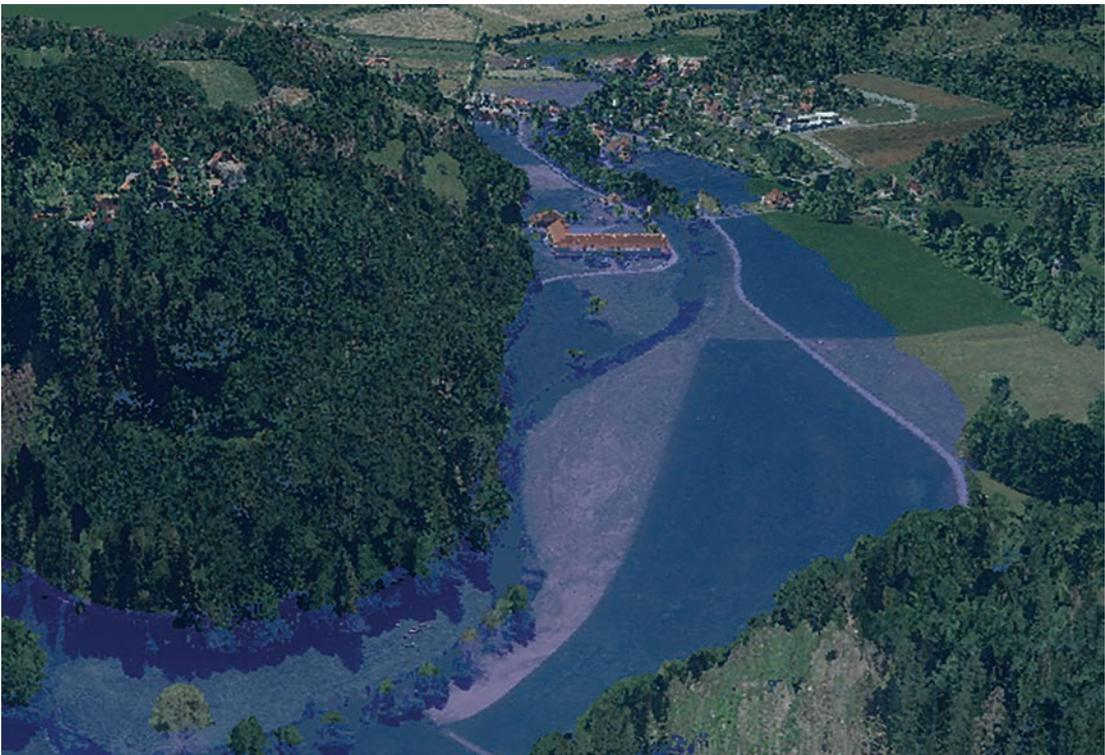
Abb. 6: Wasserstand der der Orke bei Dalwigksthalm bei einem Pegelanstieg von + 10 m
