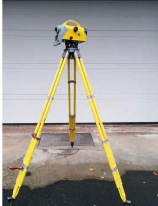
Abb. 8 und 9: Digitalnivellier Trimble DiNi auf ölgedämpftem Stativ (Fotos: HLBG)
