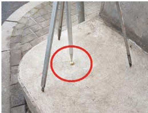
Abb. 3: Höhenbolzen 1 am Brückenkopf (Foto: HLBG)
