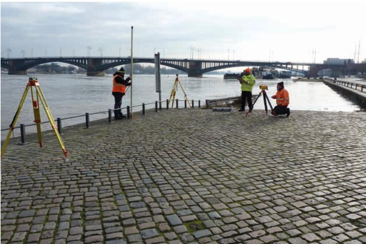
Abb. 7: Die Anschlussmessung am Hektometerpunkt 162/18 in Mainz (Foto: HLBG)
