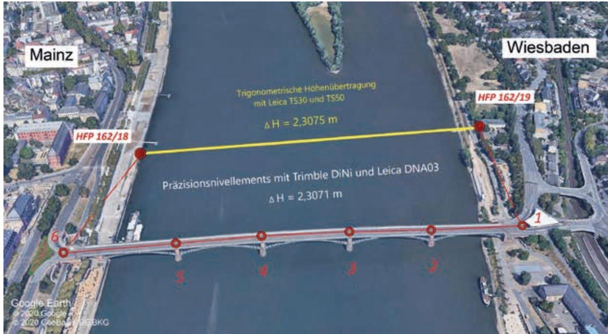
Abb. 2: Vermessungspunkte und Messanordnung im Bereich der Theodor-Heuss-Brücke (Hintergrundbild: Google Earth © 2020 Google © Geobasis DE BKG)
