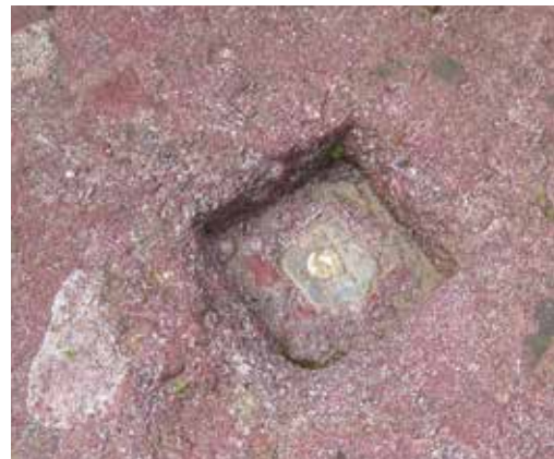
Abb. 17: Messingmarke in Steinpfeiler G
