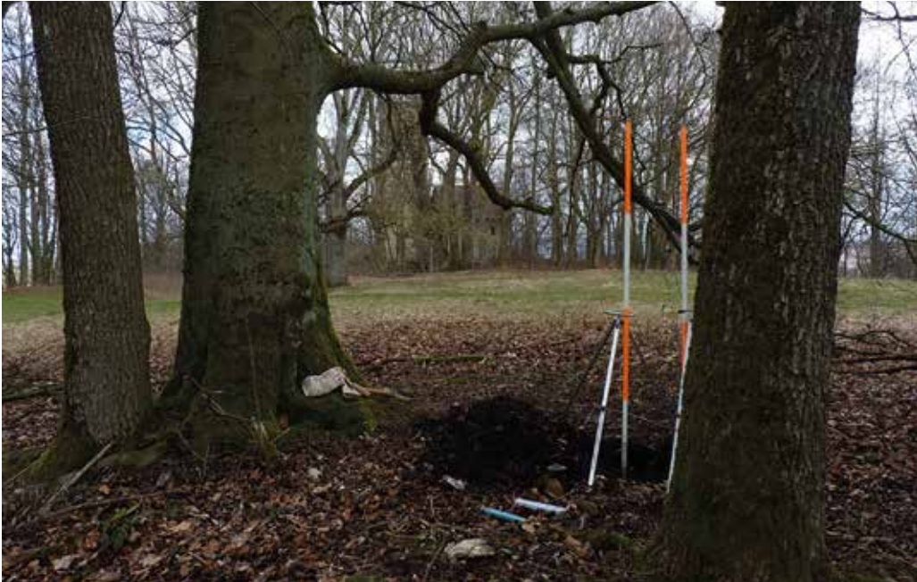
Abb. 14: Aussteckung der Signal-Standorte von 1817 (linker Fluchtstab) und 1818 (rechter Fluchtstab). Blick in nördliche Richtung mit der Ruine Boyneburg im Hintergrund.
