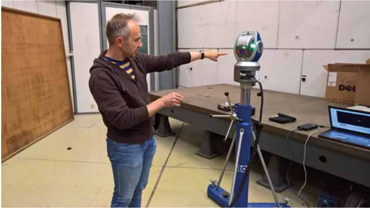
Herr Thorsten Miertsch erklärt die Funktionsweise eines Lasertrackers. (Foto: Niels Kropp)
