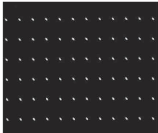
Abb. 9: Einzelne Laserpulse, aufgenommen mit der Kamera des Autokollimators
