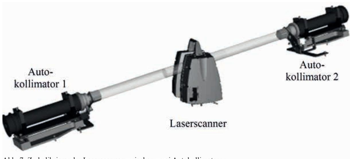
Abb. 7: Zu kalibrierender Laserscanner zwischen zwei Autokollimatoren
