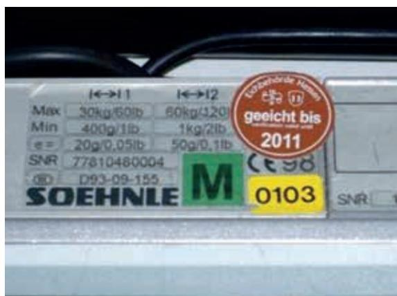
Abb. 6: geeichte Waage
