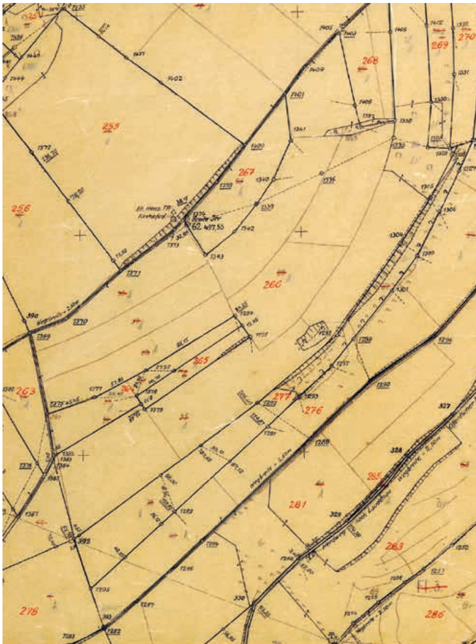
Bild 7: Tachymeterriss mit Ergänzungsmessungen: Tachymeterstandpunkte sind unterstrichen, Richtungen zu Zielpunkten angedeutet
