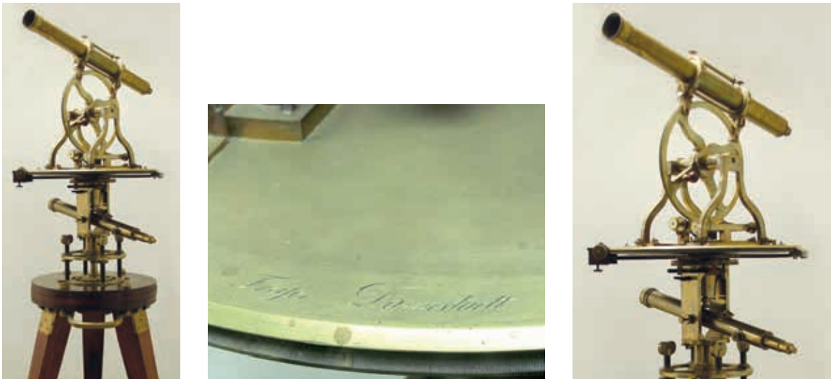
Abb. 3 bis 5: Der Fräser-Theodolit von 1805 mit der Gravur des Herstellers auf dem Limbus (mittleres Bild)
