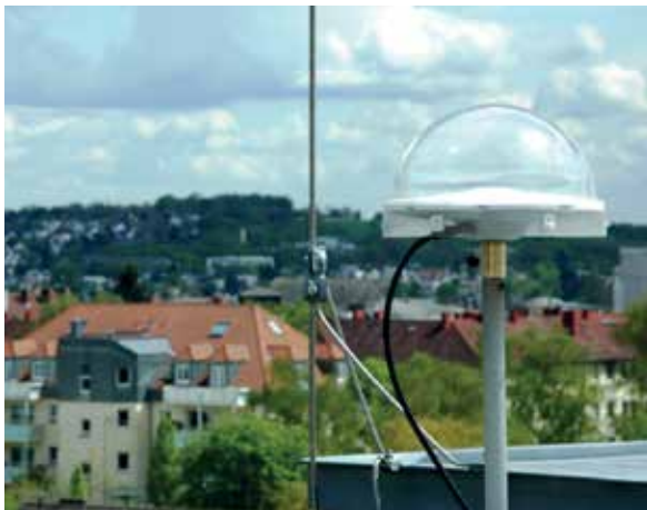
Abb. 3: Trimble Zephyr Geodetic 2 GNSS-Antenne auf der SAPOS®-Referenzstation Wiesbaden (S)
