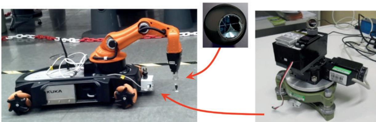
Abb. 20: Lasertracker gestützte Steuerung eines KUKA youBot
