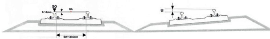
Abb. 15: Spurweite und Überhöhung (aus Hennecke et al., 1991)
