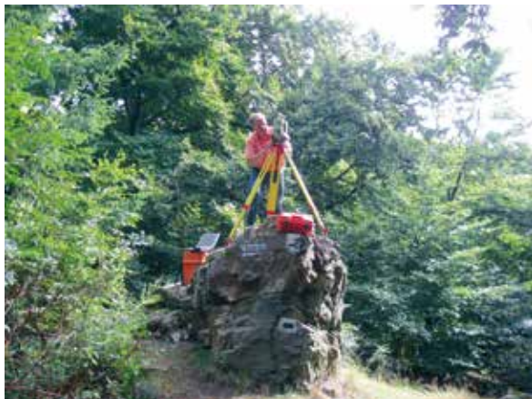
Abb. 38 und 39: Der wiedervermarkte nassauische Dreieckspunkt II. Ordnung „Hohekanzel“
