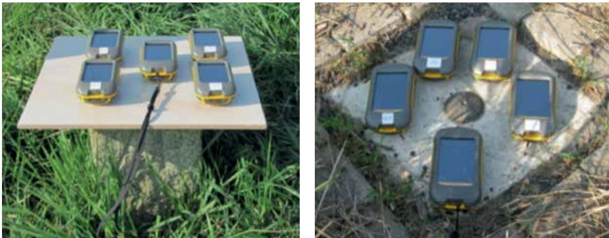
Abb. 7 und 8: Parallelmessungen auf TP 92/00 (linkes Foto) und auf RFP 421/00 (rechtes Foto)
