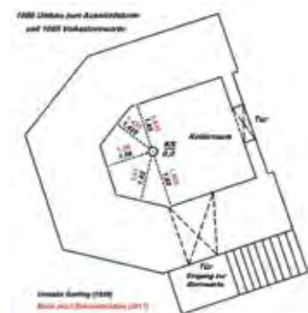
Abb. 21 und 22: Örtliche Rekonstruktion des Gerling'schen Lotpunktes im unteren Teil des Johannisbergturms
