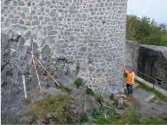
Abb. 16: Basaltformation an der Ruine Weidelsburg mit aufgebautem Reflektorstab über dem Kreuz
