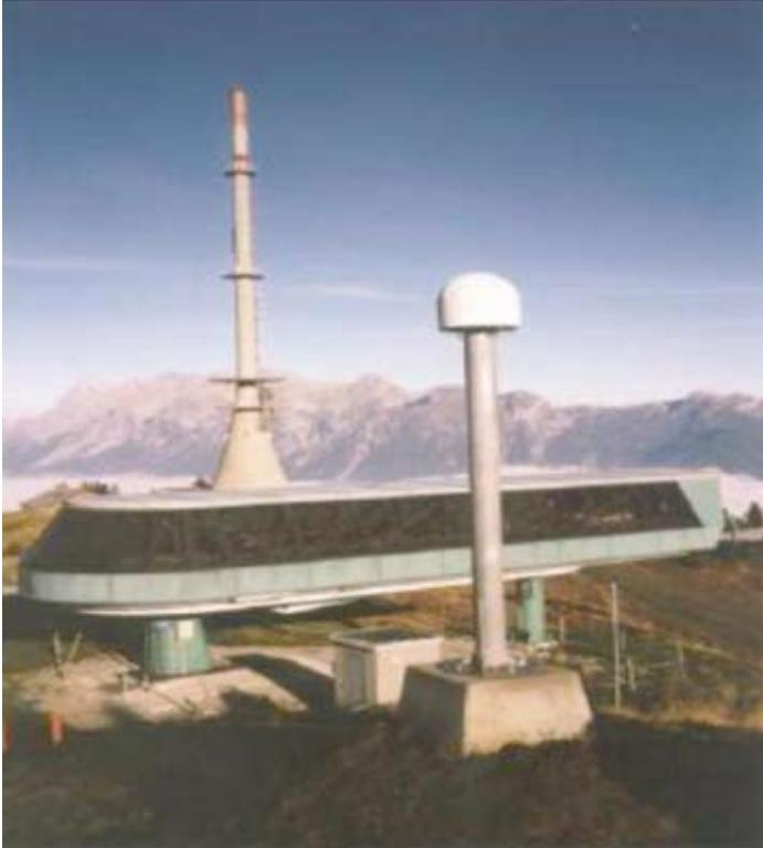
Abb. 2: Referenzstation des APOS (Station Hauser Kaibling im steirischen Ennstal)
