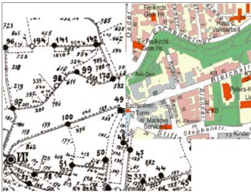
Abb. 9: Darstellung eines Ausschnittes des Leitungsnetzes aus dem Jahre 1899 mit eindeutigen numerischen Schlüsseln und Überlagerung der aktuellen Stadtgrundkarte, Maßstab 1 : 10.000
