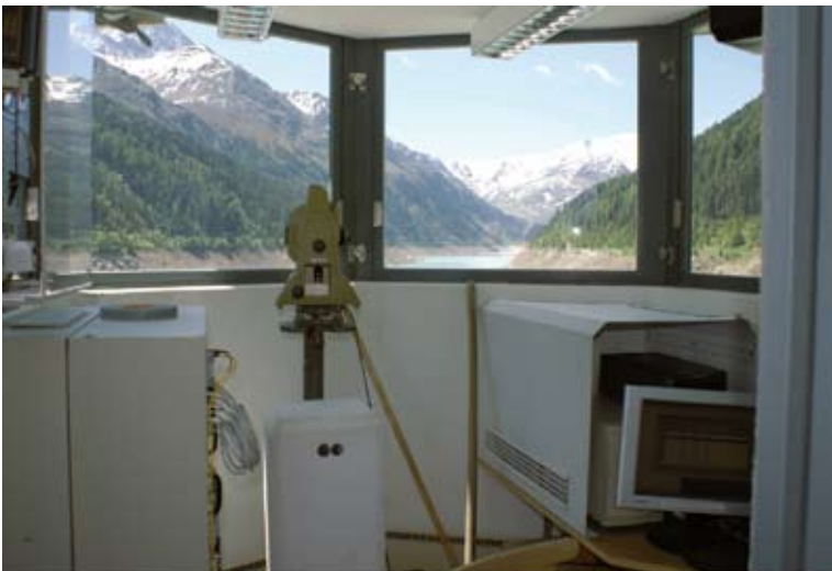
Bild 5: Permanentstation am Gepatsch-Stausee
