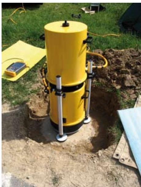
Abb. 15: Absolutgravimeter
