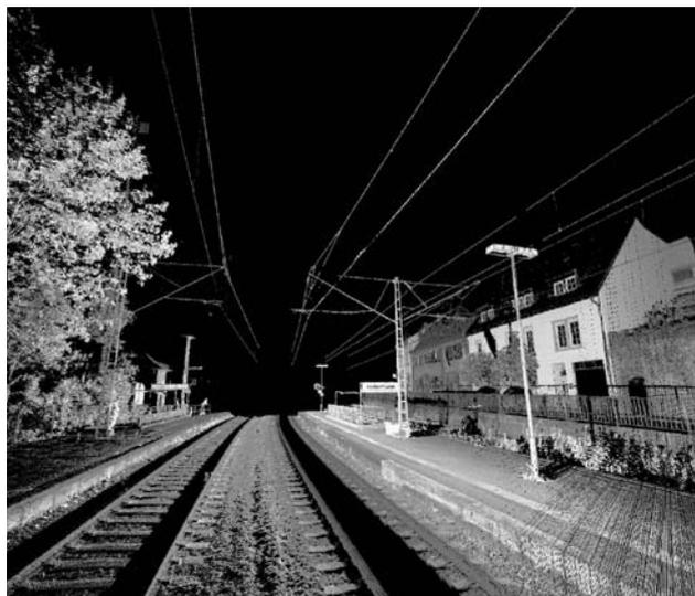
Abb. 3: Gleistopografie aus Laserscan-Messung
