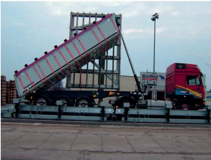
Abbildung: Nutzfahrzeug vor der Kontrollmessung auf der Prüframpe
