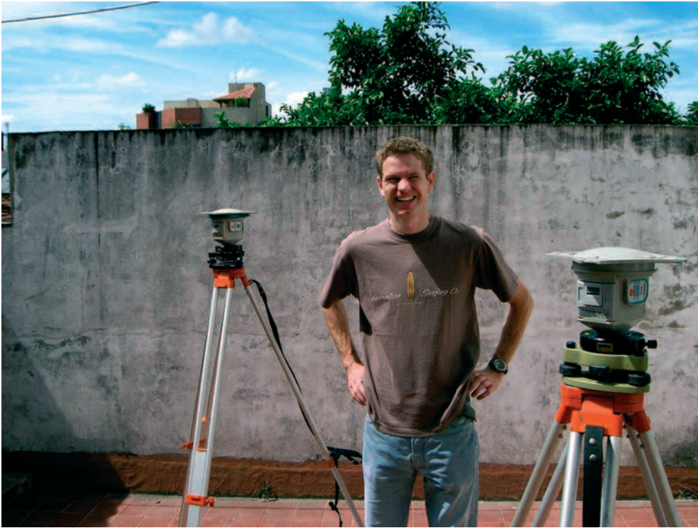
Abb. 1: Beim Kalibrieren von GPS-Antennen auf dem Dach der Firma Mertind
