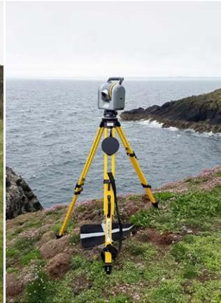
Links: Einrichten einer GNSS-Basisstation für das Postprocessing der Drohnen-daten. Es wurde ein Drohnenflug rund um Kilmichael Point, südlich von Dublin, durchgeführt.
