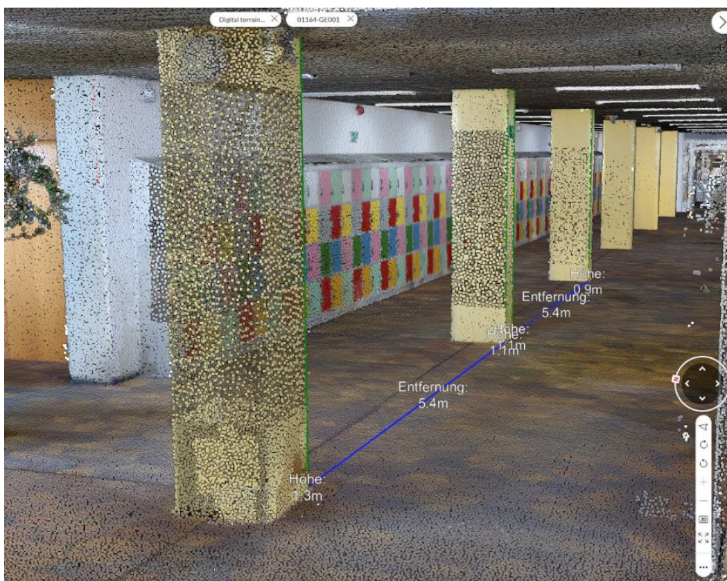
Abbildung 1.4.3.4 - 1: Visualisierung einer Punktwolke im Masterportal, Geobasisdaten © Landeshauptstadt München - Kommunalreferat - GeodatenService 2024
