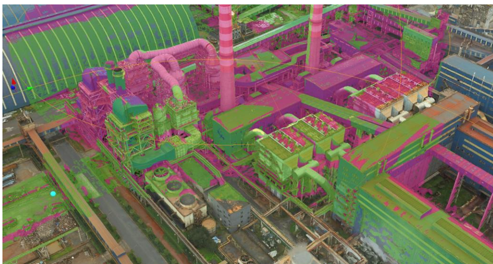
Abbildung 2.4.1 - 3: Interaktive Berechnung von Red und Green Spaces bei einer Industrieanlage
