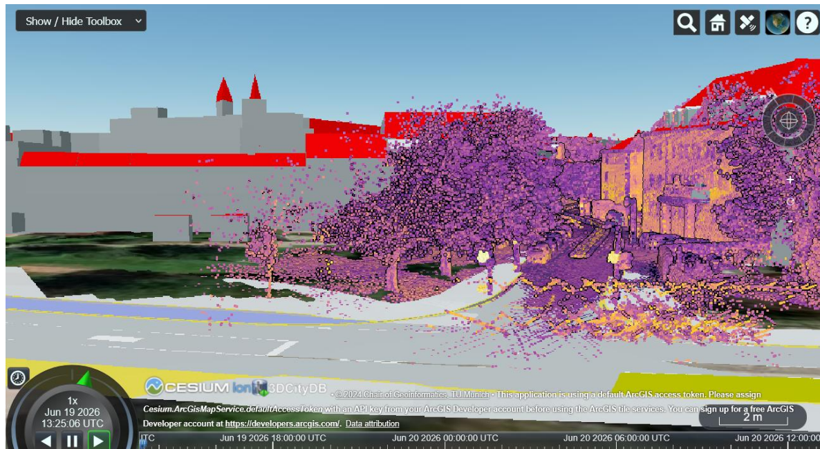
Abbildung 1.4.3.5 - 1: Gemeinsame Visualisierung einer Punktwolke (nach Intensitätswerten eingefärbt), eines semantischen 3D-Stadtmodells und eines DGM-Mesh im 3DCityDB Webmap Client (Bildquelle: https://sensordb.org/ )
