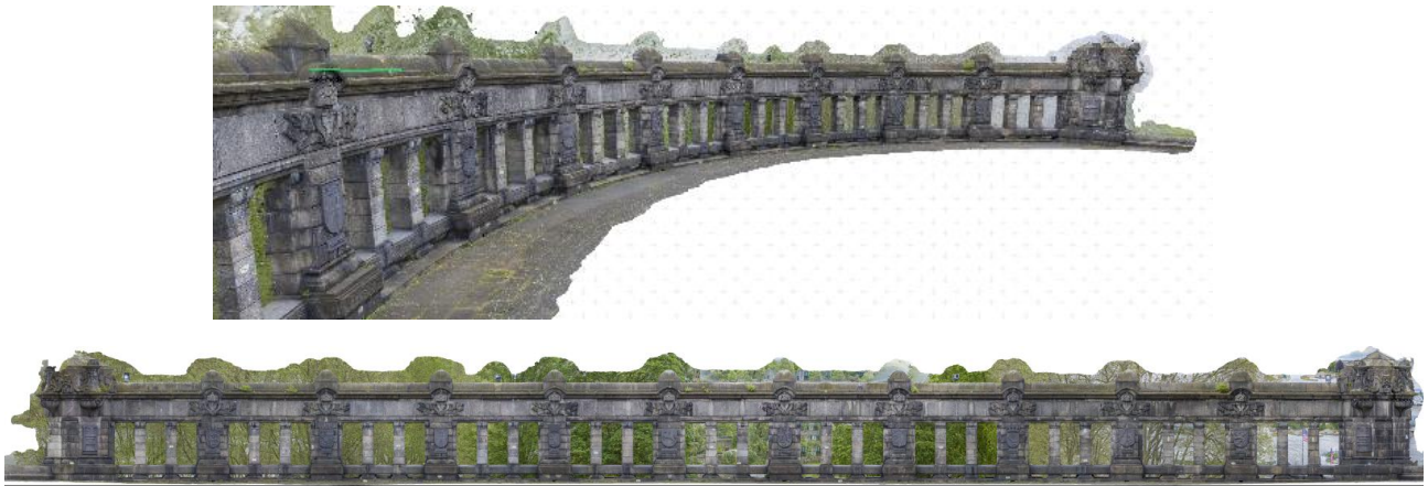
Abbildung 2.5.5 - 6: Orthoansicht, Abwicklung des Arkadenbogens (Auflösung 2mm)
