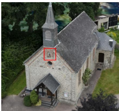
3D-Rekonstruktion einer Kapelle, erzeugt aus 448 Einzelaufnahmen mittels ArcGIS Drone2Map. Besonders bei hochdetaillierten und filigranen Strukturen - wie der dargestellten Marienstatue - wird die Leistungsfähigkeit des Gaussian Splatting-Verfahrens deutlich sichtbar.
