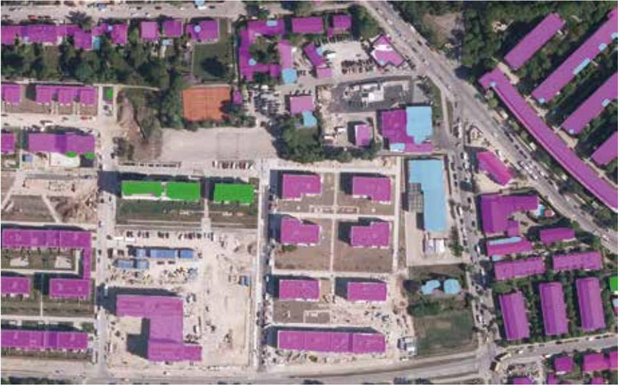
*Abbildung 1: Einsatz von KI in der Baufallerkundung: Gebäude in Bestand (lila), Altbau-fälle (blau) und Neubaufälle (grün)*
