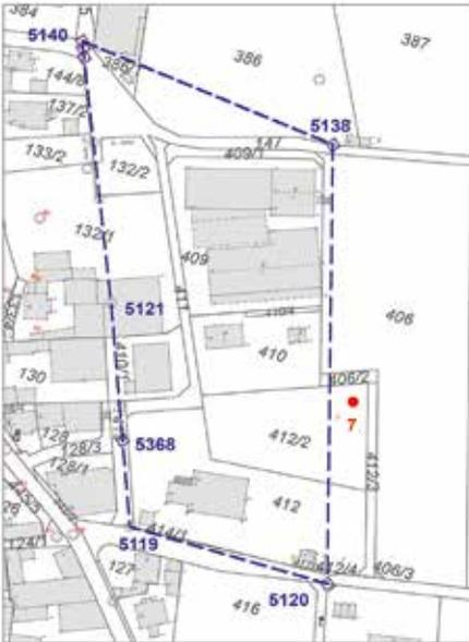
Beantragt war die Zerlegung des Flurstücks 412. Die Koordinierung erfolgte über die Punkte 5120 und 5138 analog zur Koordinierung durch die Flurbereinigung und nachfolgenden Fortführungsvermessungen.
