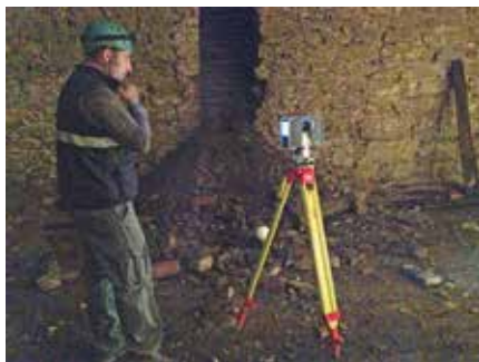
3D-Erfassung von historischen Kellergewölben mittels 3D-Laserscanning
