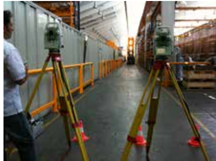
Fahrdynamische Messungen an Flurförderzeugen zur Bestimmung des Ausschwenkverhaltens des Hebewerkzeuges mit und ohne Last in Abhängigkeit von der Ebenheit von Industrieböden
