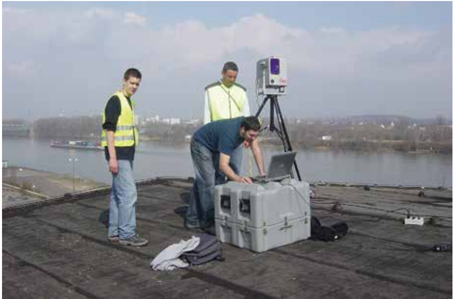
Erfassung und Dokumentation komplexer Gebäudegeometrie mittels Laerscanning
