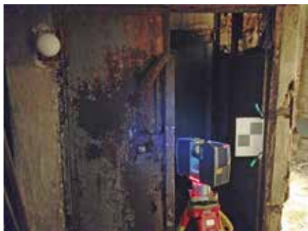
3D-Erfassung von historischen Kellergewölben mittels 3D-Laserscanning
