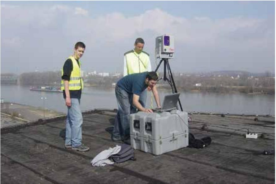
*Erfassung und Dokumentation komplexer Gebäudegeometrie mittels Laerscanning*
