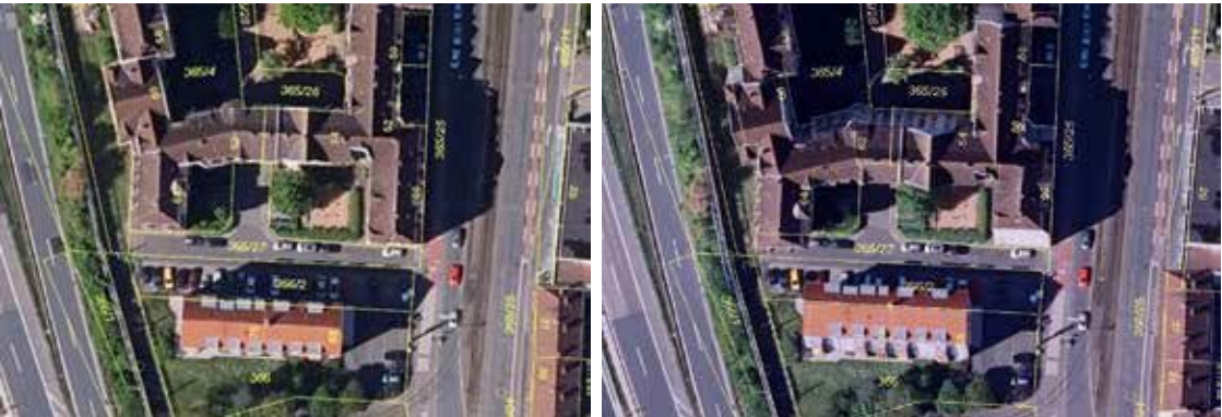
Abbildung 1: TrueDOP mit Digitaler Flurkarte Abbildung 2: Klassisches DOP mit Digitaler Flurkarte
