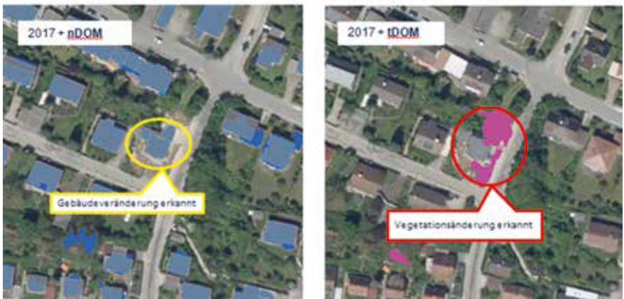
Bild 30: Gebäudeneubau wird nur im nDOM erkannt (links), negative Höhenänderung durch Baumfällung wird im tDOM erkannt (rechts).
