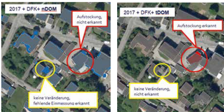
Bild 23: Überlagerung der DFK mit dem blauen nDOM (links) und dem roten tDOM (rechts)
