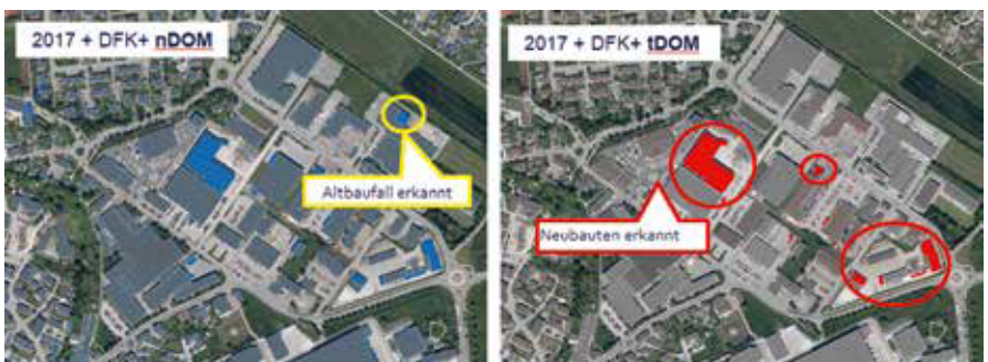
Bild 26: Überlagerung der DFK mit dem blauen nDOM (links) und dem roten tDOM (rechts)
