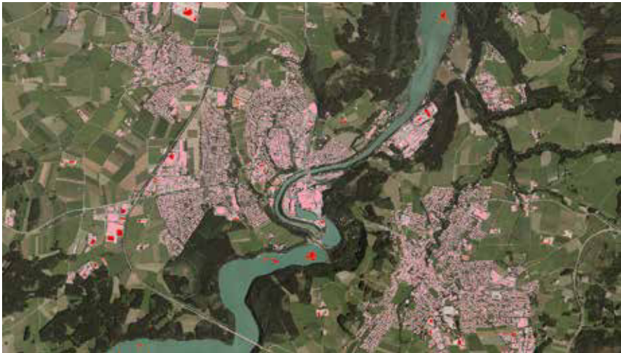
Bild 20: Überblick der erkannten Gebäude (rosa) sowie der aus zwei bDOM-Epochen berechneten Gebäudeveränderungen (rot)
