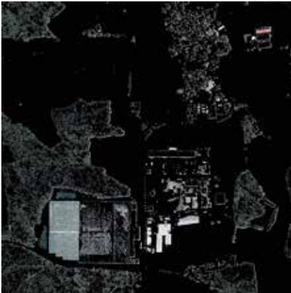
Bild 8: Punktwolke nach erster Filterung (Höhe)
