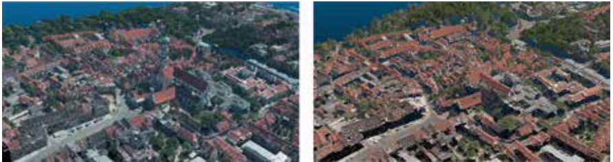
Bild 2: 3D-Punktwolke aus Image Matching (links) und abgeleitetes bDOM (rechts)
