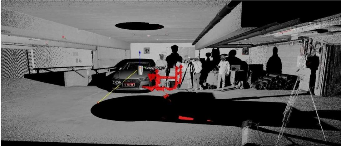
**Abbildung 13:** Der Laserscanner ist auf einem Radroboter montiert. Dabei misst er auch Teile des Roboters selbst. Diese Punkte können mit einem Entfernungsfiler (0 m – 1,8 m) markiert und entfernt werden.
