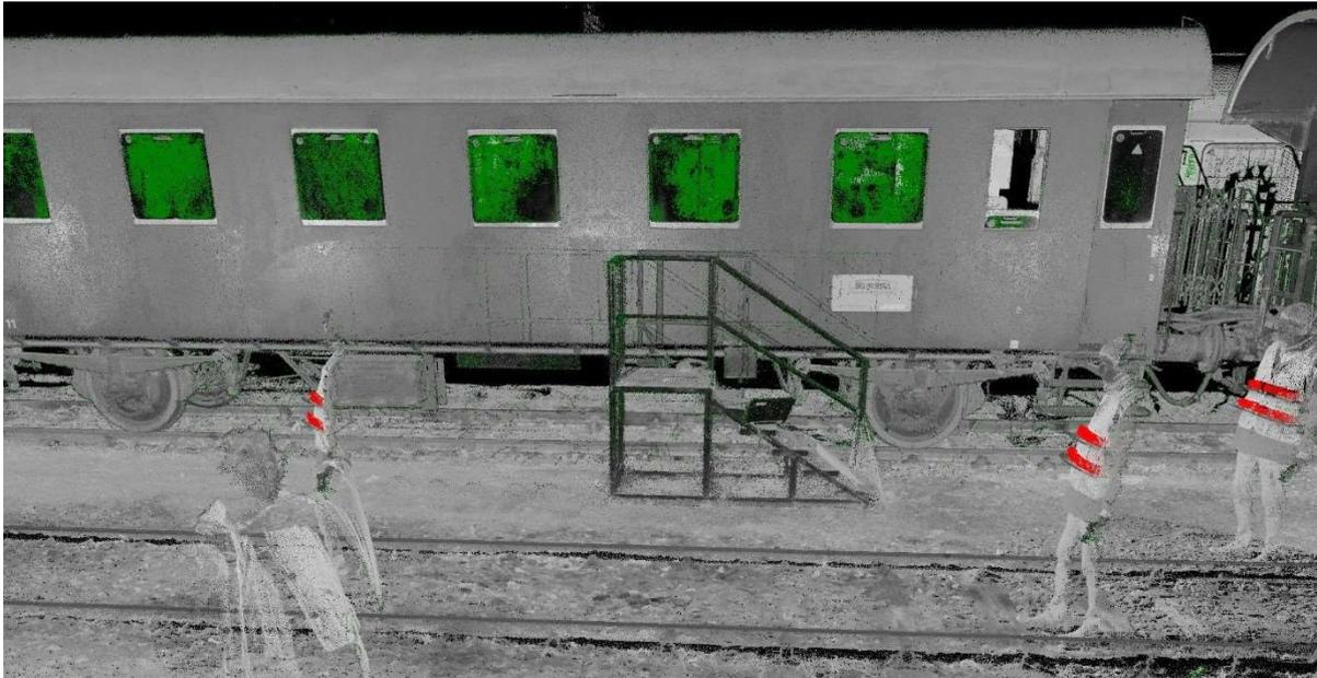
**Abbildung 10:** Rote Punkte signalisieren stark reflektierende Ziele (hier: Reflektorstreifen auf den Schutzwesen), grüne Punkte signalisieren schwach reflektierende Ziele.
