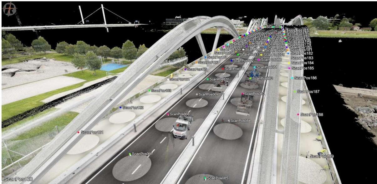
**Abbildung 3:** Eingefärbte Punktwolke aus 196 einzelnen Laserscans
