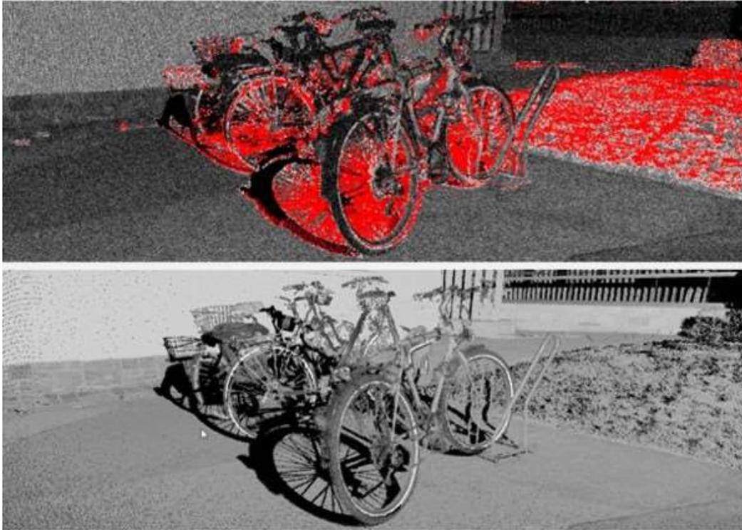
**Abbildung 11:** Oben: Alle Punkte mit einem Deviation-Wert werden markiert. Unten: Diese Punkte wurden gelöscht und mit dem Reflektanzwert grau schattiert eingefärbt.
