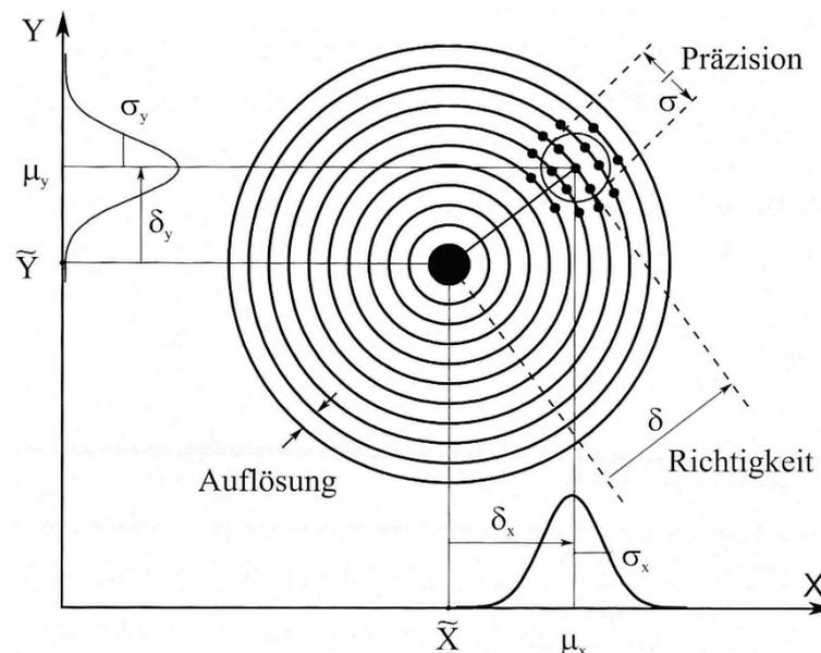
Abb. 1: Präzision, Auflösung und Richtigkeit einer Messung (hier für eine zweidimensionale Messgröße; Witte und Sparla, 2015, S. 690)
